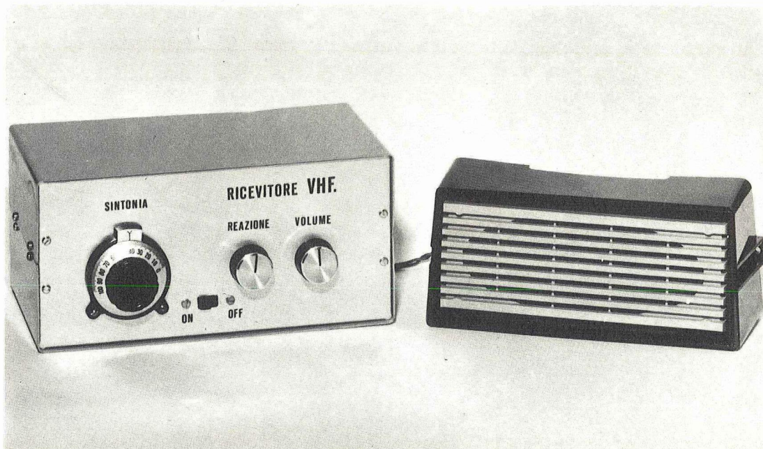
Fig. 7 Coloro che desiderano le cose perfette, potranno come abbiamo fatto noi racchiudere il tutto entro un elegante mobiletto metallico (completandolo con l'altoparlante presentato a pag. 190 del n. 3/69 di nuova Elettronica). Le scritte sul pannello sono state effettuate con lettere autoadesive rintracciabili presso ogni cartoleria.
